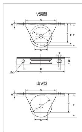
※枠、軸の材質はSUS304、車の材質は MC901です。
