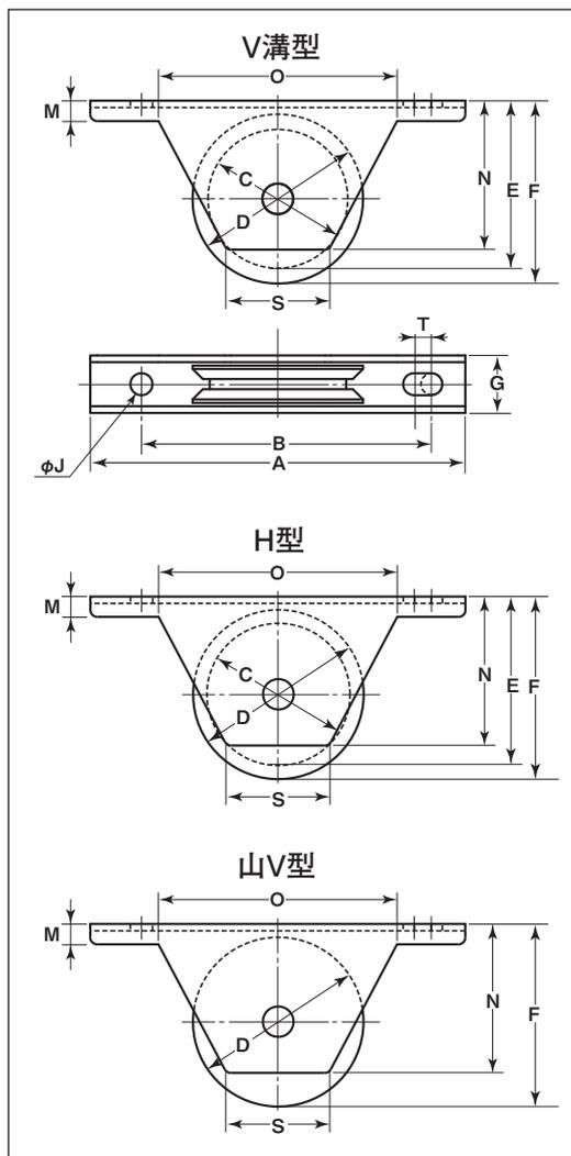
※枠、軸の材質はSUS304、車の材質はSUS303です。
