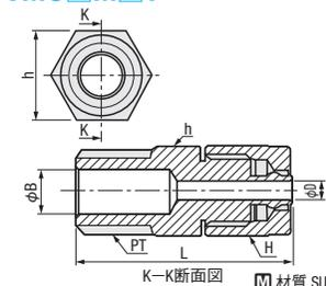
K-K断面図 材質 SUS304
