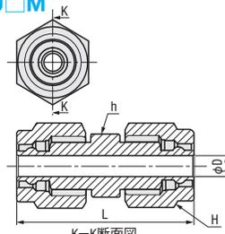
K-K断面図 材質 SUS304
