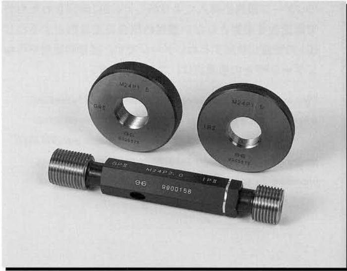
限界ねじゲージには、測定すべきねじの等級と同じゲージの等級が決められています。このゲージは通り止りの2つの寸法差を持つねじによって、ねじ部品のあらかじめ定められた寸法精度の上限と下限で検査するため、限界ねじゲージと呼んでいます。使い方としては、限界ねじゲージの通りゲージが無理なく通り抜け、止りゲージが2回転以上ねじ込まれない場合にそのゲージによる等級検査に合格したと判定いたします。
