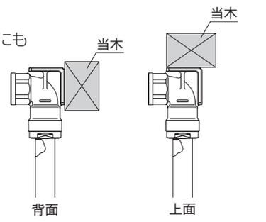
**WLSF33型** 両座水栓エルボ・保温材付 継手材質: C3771BE
