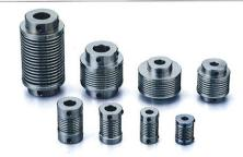
NAシリーズのベローズカップリングは、オールステンレス製です。ベローズにステンレス(SUS304L)、金具にステンレス(SUS303)を使用し、それぞれ特殊な溶接で固定されています。NBシリーズに比べて、より剛性も高く、高速高トル
