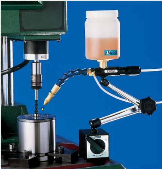
コブラ2000ドロップエジェクターは下図のようなノガ社独自のホールディングシステムと組み合わせているため自在に切削油の塗布位置を調整できます。切削油塗布量は一回あたり最大0.1ccまで自由に設定できます。コブラは切削油のみを塗布するため周囲の空気を汚さず快適な環境を保持します。また、下図Aのように補助エア吸込口を同時使用することにより間歇的なエアースプレー状の噴射もできます。更に、右図Cのように補助エア吸込口に別のエア回路を設定すると切粉除去のためのエアの噴射と切削油の塗布を交替におこなうことが出来、より効率的な冷却およびエアブロー装置としての使用ができます。CNCマシンの回路を使用することによりCNC機内でもご使用いただけます。(最大粘度 CST250 [30℃] まで)
