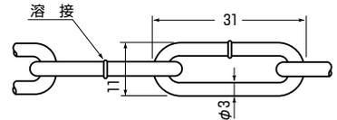
引張り強度(1.47kN(150kgf)で溶接部破断)
