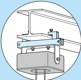
形鋼金具(SGM)と組み合わせれば、リフター付照明器具の取り付けが行えます。
