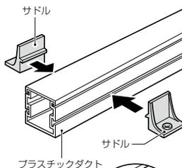
サドルをプラスチックダクトの両側面溝にはめ込み、木ネジ、アンカー等で固定します。
