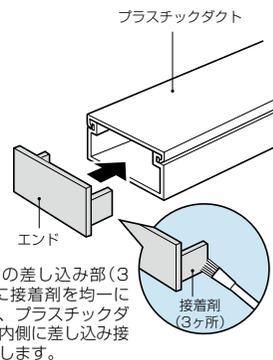
エンドの差し込み部(3ヶ所)に接着剤を均一に塗布し、プラスチックダクトの内側に差し込み接着固定します。
