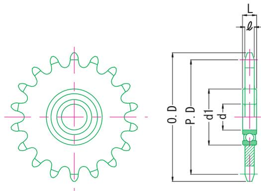
**材表** スプロケット sprocket : 鋼材S45C・三価クロメート Steel Trivalent Chromate
