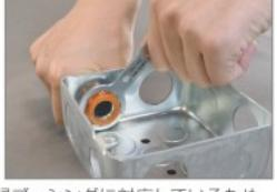
ねじなし管用ボックスコネクタの止めねじをねじ切ることができます。
